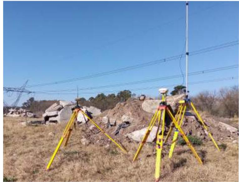
▲ GPS Trimble, antena y GPS Topcon (*fig. a*)
